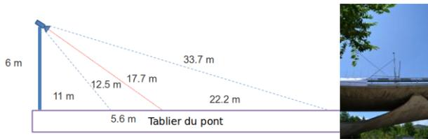
Figure 3 Schéma de montage de la camera
