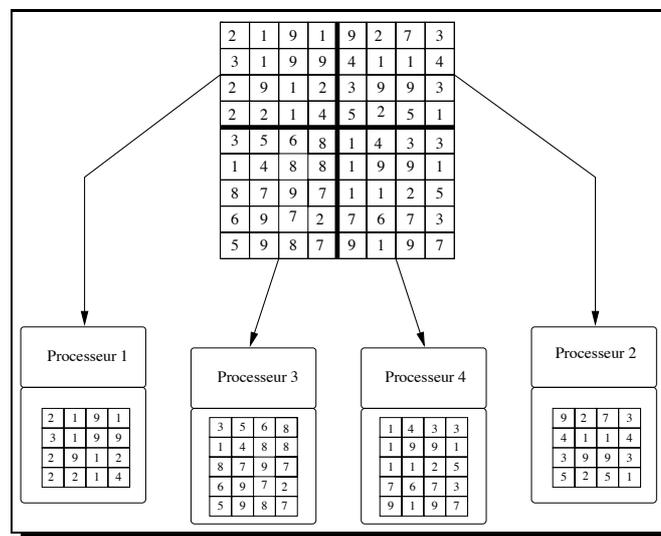
FIG. 2.14 – Projection d'une matrice sur 4 processeurs
