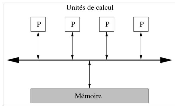
FIG. 2.10 – Réseau d'interconnexions en bus
