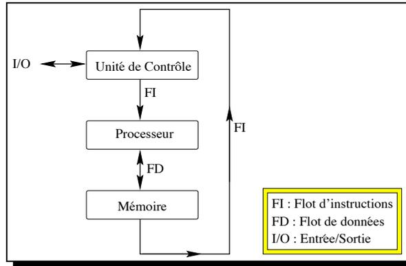
FIG. 2.1 – Architecture mono-processeur SISD
