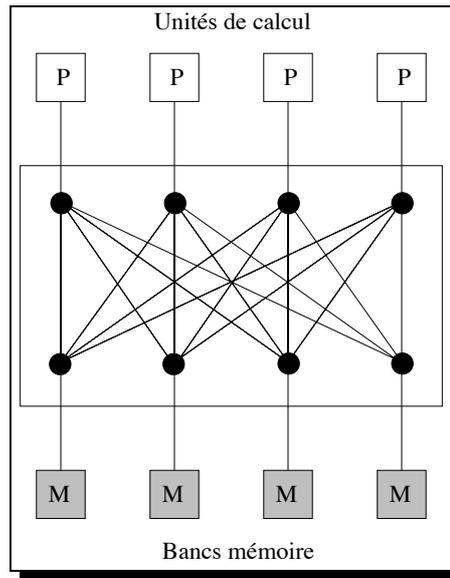
FIG. 2.11 – Réseau d'interconnexions à 1 étage
