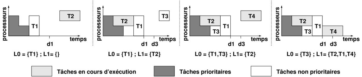
Figure 1: Illustration de l'algorithme DBF.
