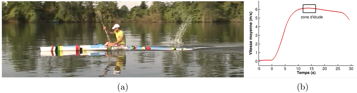
FIGURE 2 – (a) Acquisition vidéo lors de la campagne de mesure utilisée ,(b) Vitesse moyenne en fonction du temps — localisation de la zone d'étude.
