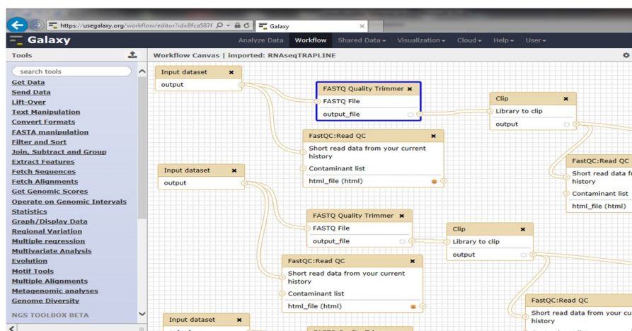
FIGURE 4 – Interface principale du système Galaxy, à gauche un ensemble d’outils disponibles qui peuvent être déplacés au centre de l’interface et liés les uns aux autres pour former une chaîne de traitement.
