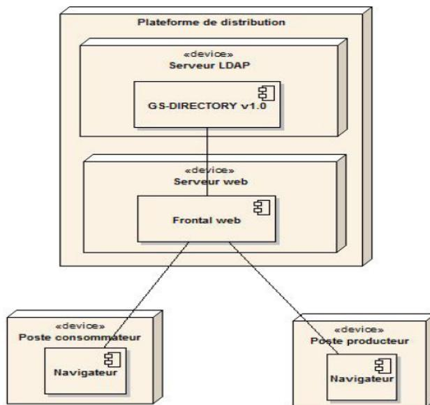
**Figure 7.** Architecture de déploiement des composants de test
