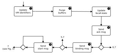
Figure 5. VM Configurator Lifecycle Handling VM Failures
