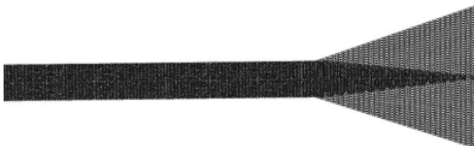
Figure 5. Maillage de la conduite convergent-divergent, 14833 noeuds, 29184 éléments
