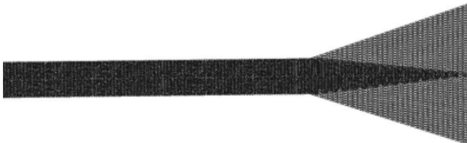
Figure 5. Maillage de la conduite convergent-divergent, 14833 noeuds, 29184 éléments
