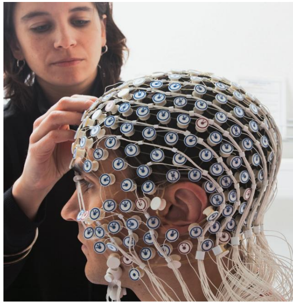
FIGURE 1.6 – Exemple de casque EEG avec un grand nombre d'électrodes utilisé en laboratoire de recherche.
