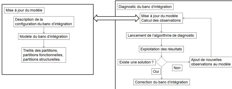
FIGURE 8 – Architecture de la suite logiciel
