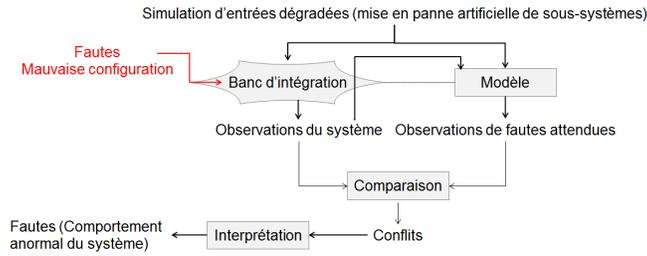
FIGURE 2 – Diagnostic à base de modèle du banc d'intégration
