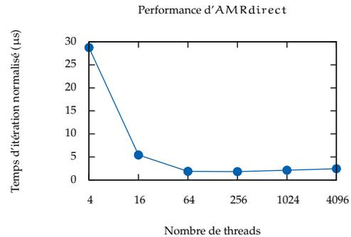
(b) Temps d'itération normalisé par le nombre de connecteurs en fonction du nombre de threads. Les composants ne calculent pas. Les temps sont les médianes sur > 10 exécutions pour chaque point. Les expériences ont été faites sur un Intel i7-3520M bi-cœur à 2.9GHz.
