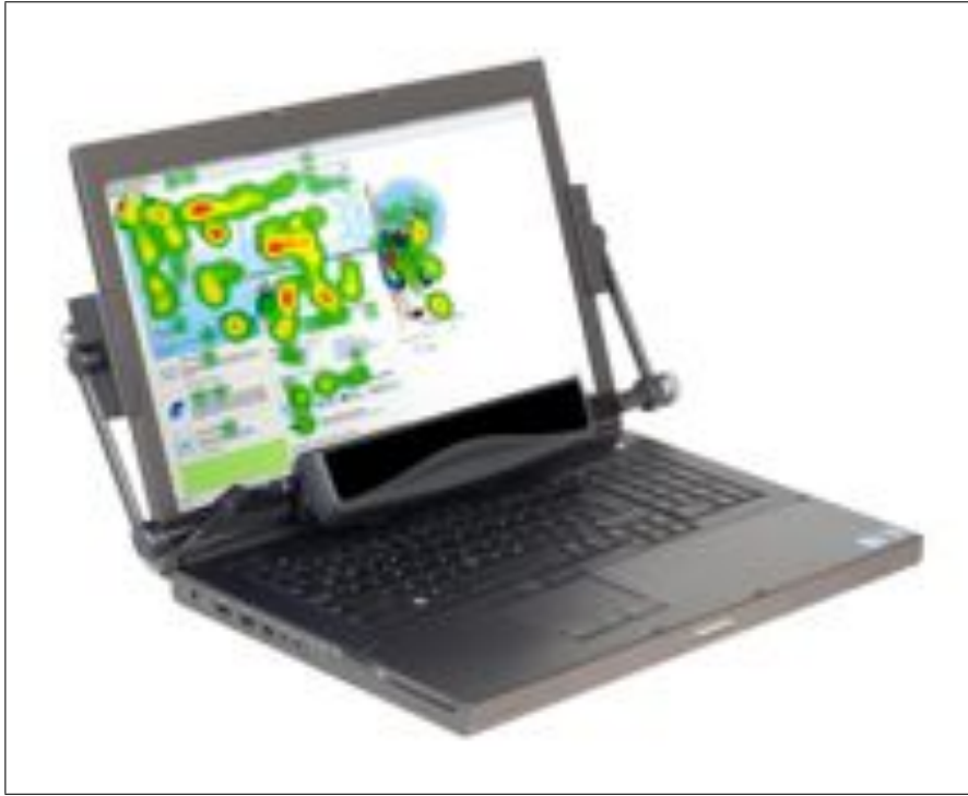
FIGURE 2.4 – Exemple de dispositif expérimental ressemblant fortement à celui utilisé lors de notre expérience. Le dispositif est composé d’un ordinateur sur lequel est installé le logiciel Tobii Studio. L’eye tracker repose sur la base de l’ordinateur.
