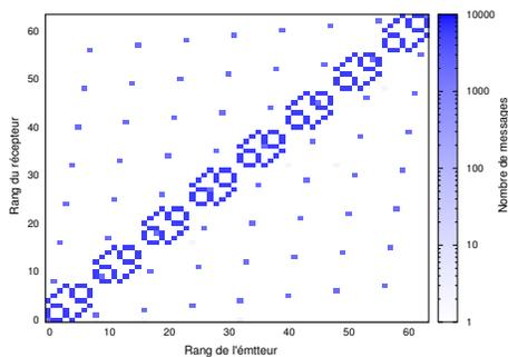
FIGURE 3 – Schéma de communication de CG
