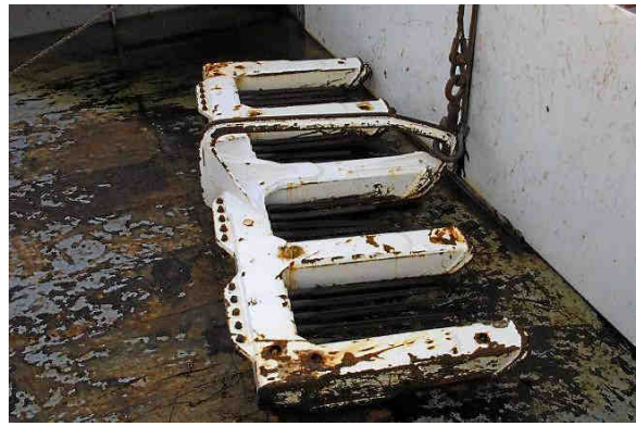
Figure 22 - Le peigne Norvégien utilisé pour la récolte de Laminaria hyperborea
