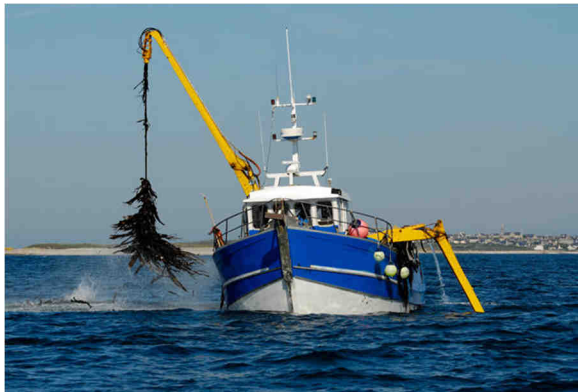
Figure 21 - Le scoubidou utilisé pour la récolte de Laminaria digitata
