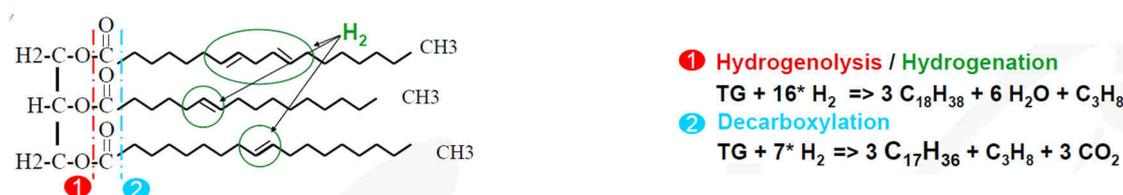
Figure 19 – Réaction d'hydrogénation, transformant des lipides (triglycérides) en HVO (Hydrotreated Vegetable Oils) c'est à dire alcanes (C<sub>n</sub>H<sub>2n+2</sub>) et propane (C<sub>3</sub>H<sub>8</sub>) [9]
