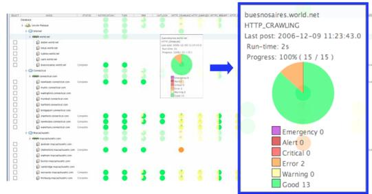
**FIGURE 5.** Utilisation de grilles de diagrammes circulaires pour visualiser des bancs d'essai de services [YFB<sup>+</sup>07].
