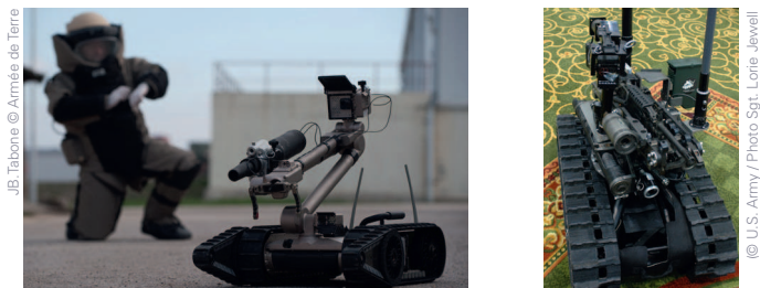
Figure 9 : À gauche, matériel d'élimination d'objets détonants de l'Armée de Terre : Le robot radio-télécommandé Packbot 510 possède plusieurs caméras orientables ; à droite, robot armés de l'armée américaine
