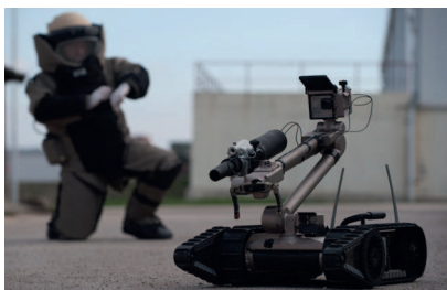
Figure 9 : À gauche, matériel d'élimination d'objets détonants de l'Armée de Terre : Le robot radio-télécommandé Packbot 510 possède plusieurs caméras orientables ; à droite, robot armés de l'armée américaine
