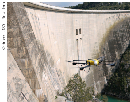
Figure 7 : À gauche, drone d'inspection Novadem ; à droite, Throwbot® X, robot de reconnaissance tactique utilisé par la police ou l'armée
