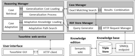
Fig. 2. Architecture of TUUURBINE
