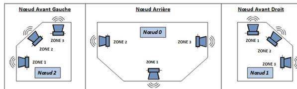
Fig. 2. Placement des capteurs pour les trois nœuds
