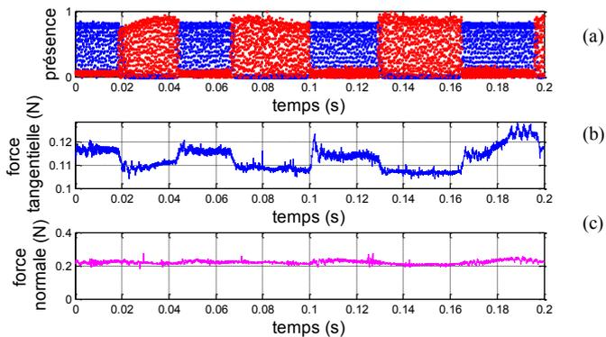
Fig. 11 (a) Présence et absence en alternance de l'électrovibration (bleu) et de l'effet *squeeze film* (rouge), (b) effort tangentiel (en N) subi par le doigt, (c) effort normal (en N) appliqué par le doigt sur la dalle.
