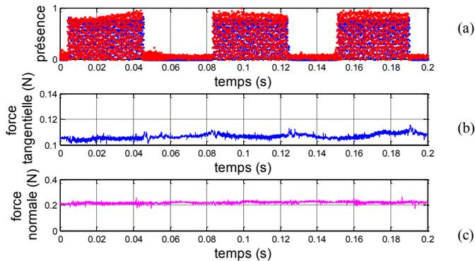
Fig. 10 (a) Présence et absence simultanées de l'électrovibration (bleu) et de l'effet *squeeze film* (rouge), (b) effort tangentiel (en N) subi par le doigt, (c) effort normal (en N) appliqué par le doigt sur la dalle.
