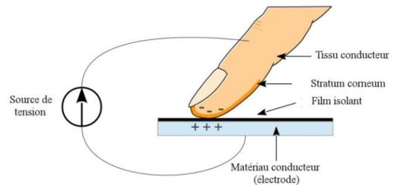
Fig. 5 Principe de l'électrovibration
