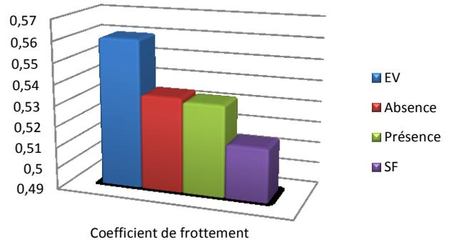
Fig. 12 Évolution du coefficient de frottement pour les quatre cas possibles de modulation de frottement.
