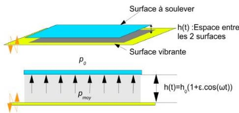
Fig.1 Principe de l'effet *squeeze film*
