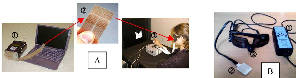
**Figure 1 :** Version TDU du TVSS et ses 3 composants (①interface informatique/contrôle de l'intensité de stimulation, ②matrice buccale, ③micro-caméra). A : version 1998 de Kaczmarek et Tyler ; B : version 2010 *BrainPort® Vision Devive V100*.
