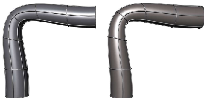
Fig. 4.6: Visualisation du résultat de la correction de volume pour un angle de 90^\circ . Le cylindre de gauche correspond au cas obtenu par simple skinning, alors que le cylindre de droite correspond à celui obtenu après correction de volume.
