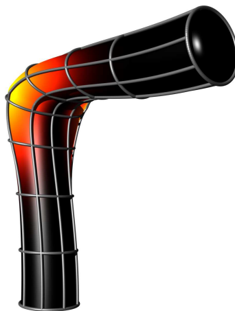
Fig. 4.13: Résultats obtenues pour le cas d'une correction normale à la surface. Le cylindre est déformé pour des angles de plus en plus importants.
