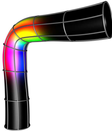
Fig. 4.10: Codage couleur des déplacements suivant leur direction et leur amplitude pour le cas de la correction pondérée. L'exemple est pris pour p=8 et q=15 .
