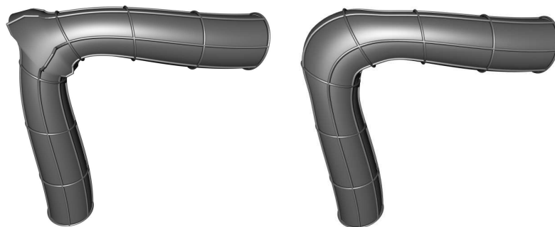
Fig. 4.12: Cas extrêmes de la déformation très localisée. La figure de gauche montre le cas où la déformation est trop localisée ( q=10 ) et pas assez lissée ( p=1 ), alors que celle de droite montre une déformation trop localisée ( q=10 ) et très lissée ( p=30 ).
