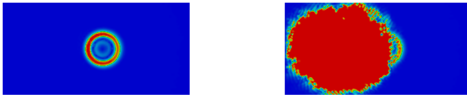
Figure 3 – Norme euclidienne du déplacement à l'instant t = 1 , pour s = 1 (à gauche) et s = 0 (à droite).
