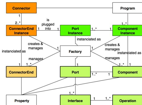
Figure 3 : Concepts et relations du modèle Ethylene.
