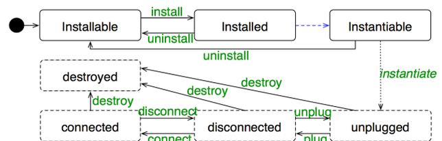
Figure 4 : Cycle de vie d'une extrémité de connecteur
