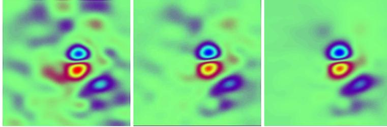
FIG. 4 – Composante  $u$  du champ de vitesse analysé pour une séquence d'observation correspondant au bruit fort (SNR 14.8 dB). À gauche est présenté le résultat d'une assimilation basée sur la distance entre pixel, au centre sur la distance entre gradients, à droite sur la distance entre les coefficients d'ondelettes de Daubechies (avec la matrice de covariance définie en (14)).
