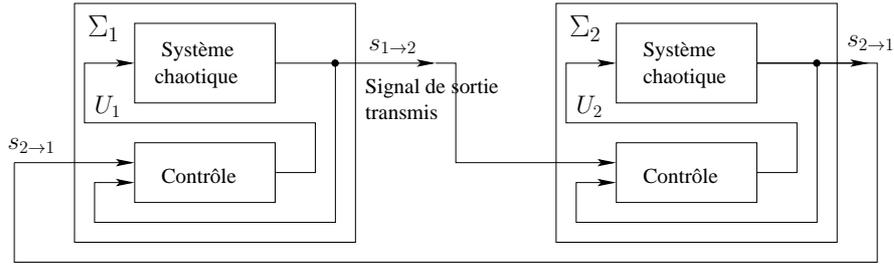
**Figure 1.** Représentation schématique des systèmes bidirectionnellement couplés
