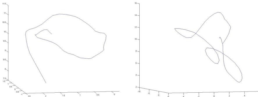
Si les mouvements à reconnaître forment un ensemble de commandes d'opérateur connues à l'avance, et que ces commandes ont des courbes d'accélérations très caractéristiques, on peut mettre en place des filtres simples qui permettent de reconnaître le mouvement à partir des courbes des accéléromètres en détectant des extremas. Le problème de cette méthode est que le mouvement effectué n'est jamais strictement identique et donc définir les niveaux des filtres reste difficile.
