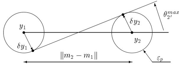
Figure 4.2 : Angle d'ajustement maximum  $\theta_{2'}^{max}$  pouvant être obtenu.
