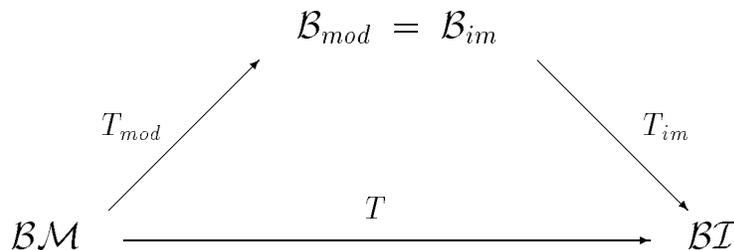
Le modèle étant parfait, le calcul de  $T_{mod}$  ne pose aucun problème. Par contre, les mesures des points de la scène (dans  $\mathcal{BI}$ ) sont sujettes à l'erreur. Cette erreur se répercute dans le calcul de  $T$  ou  $T_{im}$  et donc sur le positionnement supposé des autres points du modèle.
