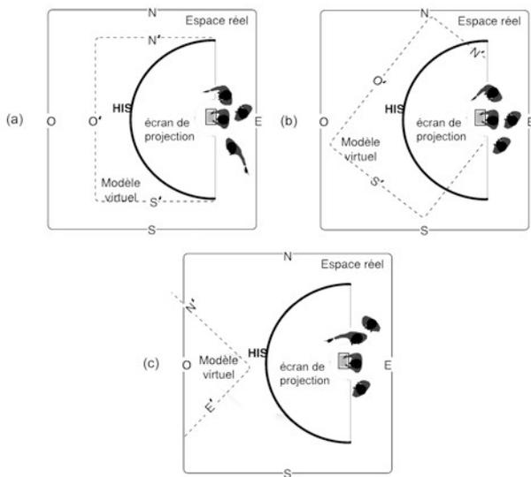
**Figure 10 : Vue en plan des trois configurations possibles du rapport réel/virtuel aligné (a), non-aligné (b) et extérieur (c). Les lettres N,E,S et O font référence aux murs Nord, Est, Sud et Ouest de l'espace réel, N', E', S' et O' au modèle virtuel.**
