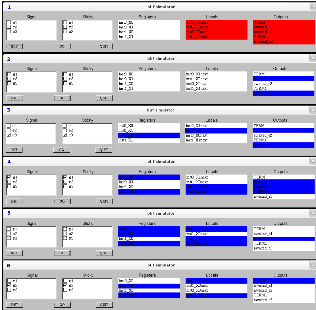
Figure 4.11 — Simulation du fonctionnement du modèle de deux scénarios "Before" synchrones (e3 Before e1, e1 Before e2) en utilisant l'outil Blif_simul .
