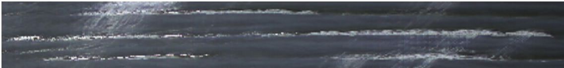
FIGURE 9. Timestack associé : les lignes horizontales sont les crêtes des vagues, l'orientation des autres lignes formées par les résidus des mousses donne la vitesse des courants de surface le long de la côte.
