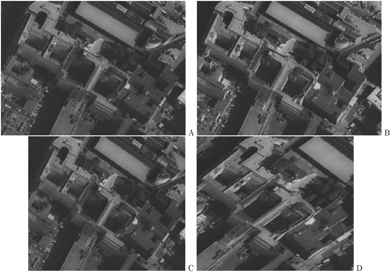
FIG. 14: Résultats obtenus en estimant la transformation locale. A et B sont les deux images initiales. C et D sont les images reconstruites avec x_{q_e} = 1 et x_{q_h} = 2 (Ce choix des coefficients permet de limiter les déformations introduites par le rééchantillonnage). Les façades étudiées sont celles dont l'orientation est de 115^\circ par rapport aux lignes. Dans les images initiales, ces façades sont perçues différemment et ne peuvent être appariées. Dans les images reconstruites, nous voyons qu'elles sont à présent dans une même géométrie.
