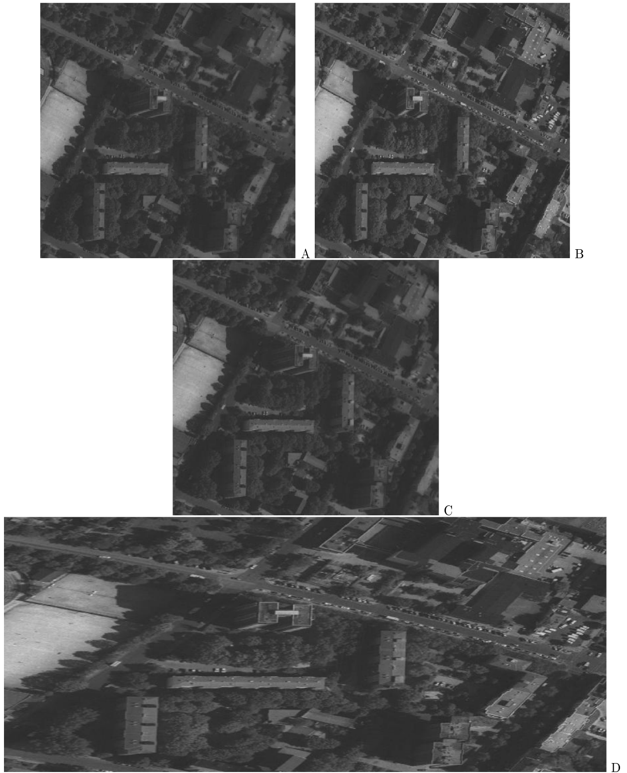
FIG. 8: Résultats obtenus en appliquant la transformation aux courbes épipolaires. A et B sont les deux images initiales et C et D les images reconstruites. Les façades sont perçues différemment dans les images initiales. Dans les images reconstruites, nous voyons que les façades des bâtiments dont l'orientation est perpendiculaire aux lignes sont à présent de surface équivalente. Les toits (correspondant à des surfaces horizontales) sont "étirés" et leurs surfaces sont perçues différemment. Nous pouvons voir aussi, dans le coin en haut à droite des images C et D, que les façades verticales, qui possèdent une orientation non orthogonale aux lignes des images, ne présentent pas les mêmes surfaces. La transformation n'a pas donné le résultat désiré pour leur cas.
