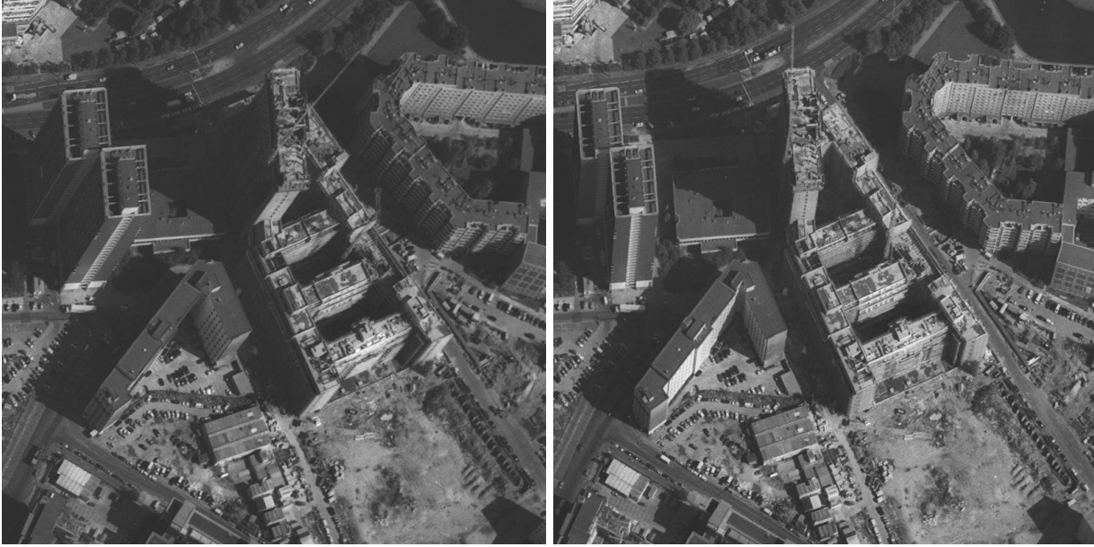
FIG. 1: La paire d'images présente les problèmes que nous rencontrons avec les façades. Les surfaces verticales sont déformées et n'ont pas la même taille dans les différentes vues. Leur appariement est difficile.
