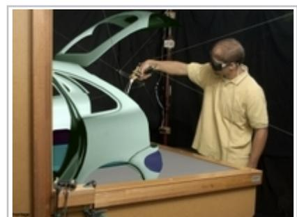
Simulation de dépose de cordons d'étanchéité sur carrosserie avec outil et retour haptique (2004) - Collaboration avec PSA Peugeot Citroën
