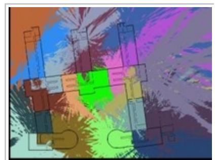
En 2004, simulation de la couverture WiFi en différents endroits d'un immeuble - © Inria - Equipe Ares
