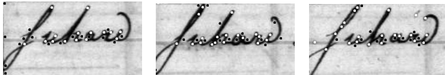
Figure 1. Instabilité des points d'intérêts détectés par des DOG
