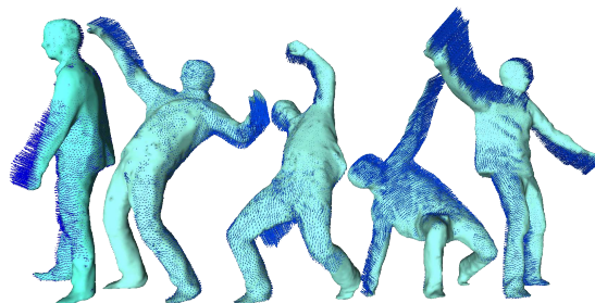
FIGURE 1 – Exemple de flot de scène dense (en bleu) calculé à partir de correspondances de points d'intérêts 2D et 3D et de flot de normal dense.
