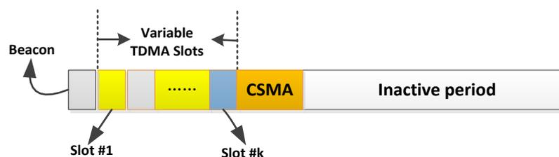
FIG. 1 - Structure de la « superframe » de Queue-MAC
