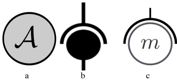
Figure 4 : symboles des composants du méta-modèle AA4MM (a) m-agent, (b) artefact de couplage, (c) artefact d'interface et son modèle  $m$ .
