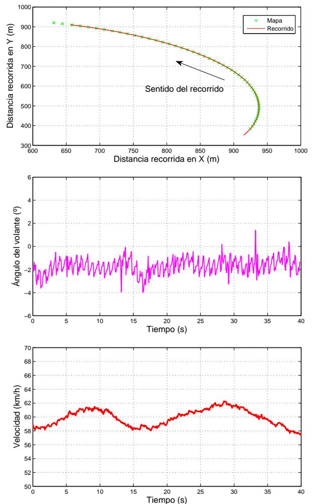
Fig. 6. Mapa y posición del vehículo en coordenadas X-Y, ángulo del volante y velocidad para velocidades próximas a 60 km/h.
