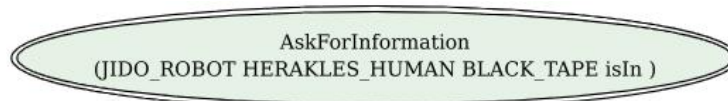
FIG. 7 – Le plan produit par HATP contient uniquement une action de communication permettant au robot d'obtenir l'information manquante.
