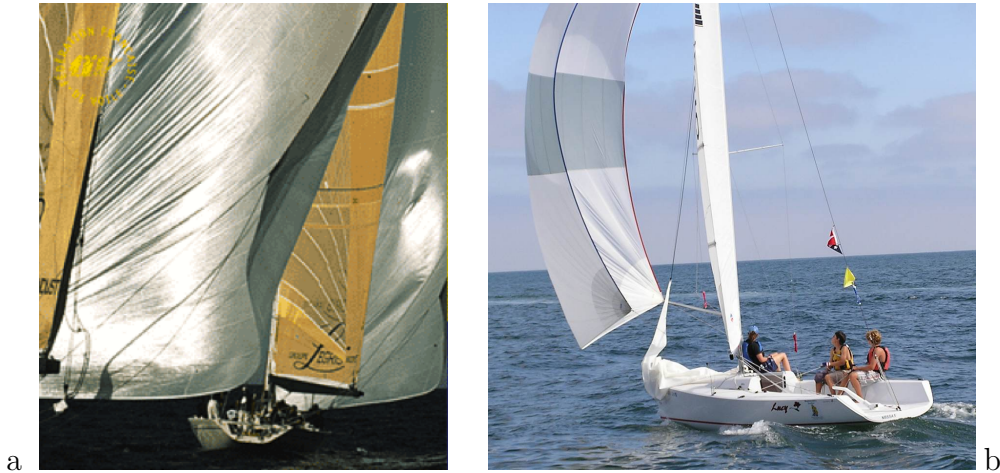
Figure 1: Examples of wrinkled downwind sails – a : Courtesy of Christian Février and b : Courtesy of Bravura Yachts
