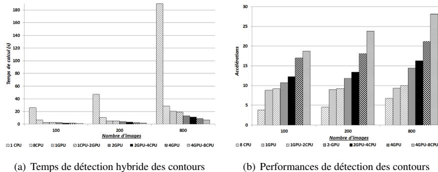
Figure 7. Performances de détection des contours sur architectures hétérogènes
