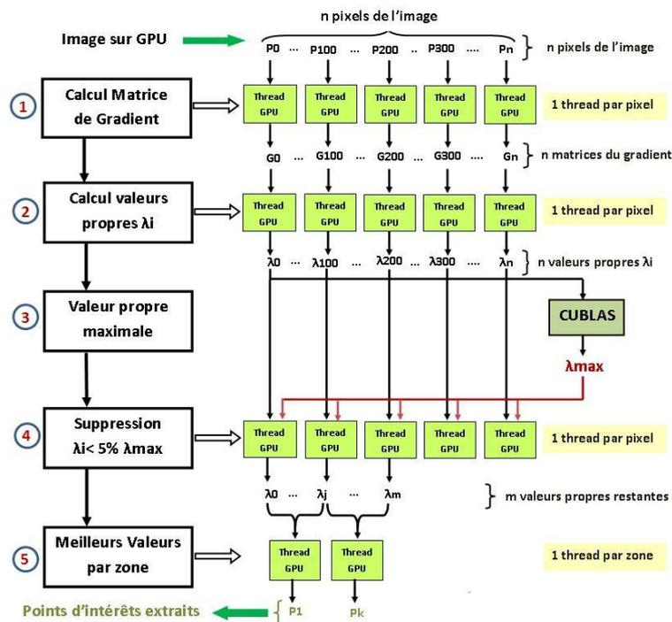
Figure 2. Détection des points d'intérêts (coins) sur GPU
