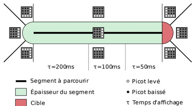
Figure 3 : Guidage sur un segment
