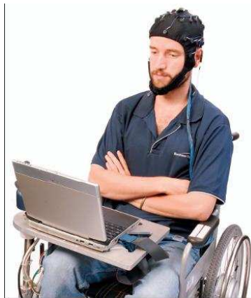
Figure 2. Un fauteuil roulant contrôlé uniquement par l'activité cérébrale (image mise gracieusement à disposition par Brice Rebsamen)
