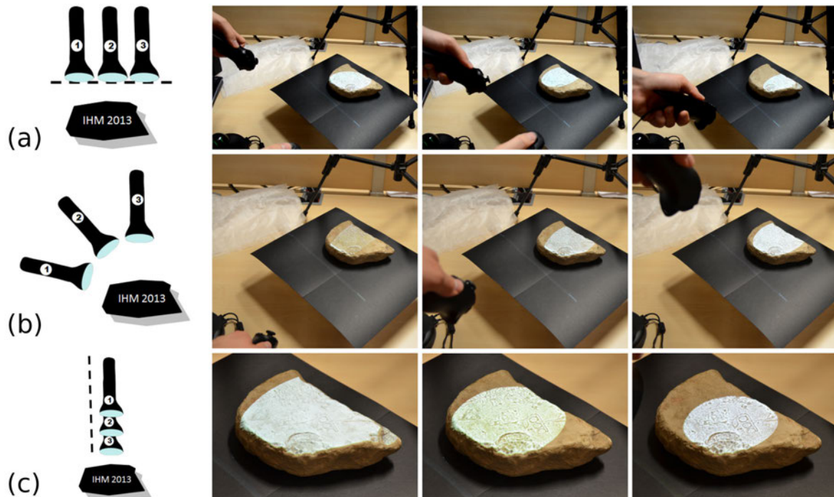
Figure 4. La Lampe torche magique dans le mode Radiance Scaling : SPOT : Illustration de l'influence de la position du spot lumineux sur l'objet (ligne (a)). ANGLE : Illustration de différents angles d'éclairage (ligne (b)). DISTANCE : Illustration de l'accentuation des zones à fortes courbures en fonction de la distance de la Lampe torche magique (ligne (c)).
