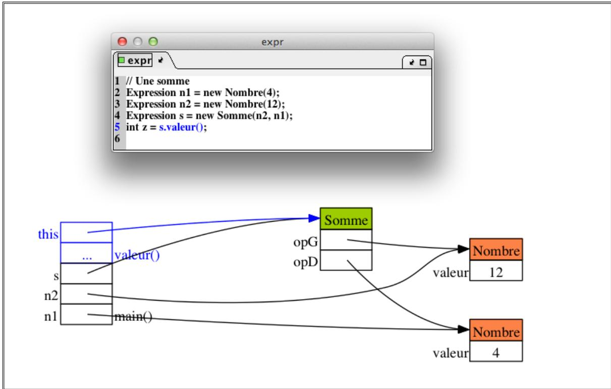
Figure 4 : Illustration du mécanisme de la liaison dynamique ;
